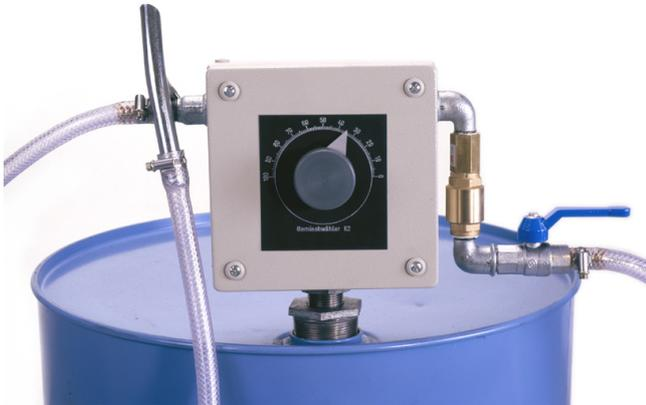
Das TESTRÖ-MIX Fassaufsatzmischgerät arbeitet nach dem Injektor-Venturi-Prinzip, wobei der Wasserfließdruck ein Vakuum erzeugt. Dadurch wird die eingestellte Menge des wassermischbaren Kühlschmierstoffes angesaugt und in der Wasserstrahlpumpe optimal zu einer stabilen und homogenen Emulsion vermischt.
