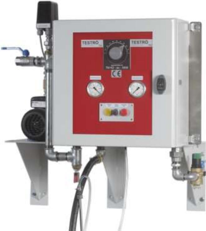
**Auch als Konsole sorgen unsere Misch- und Versorgungsstationen vollautomatisch und zuverlässig für eine konstante Befüllung der Werkzeugmaschinen. Die Mischgerätebestückung erfolgt nach Wahl.**
